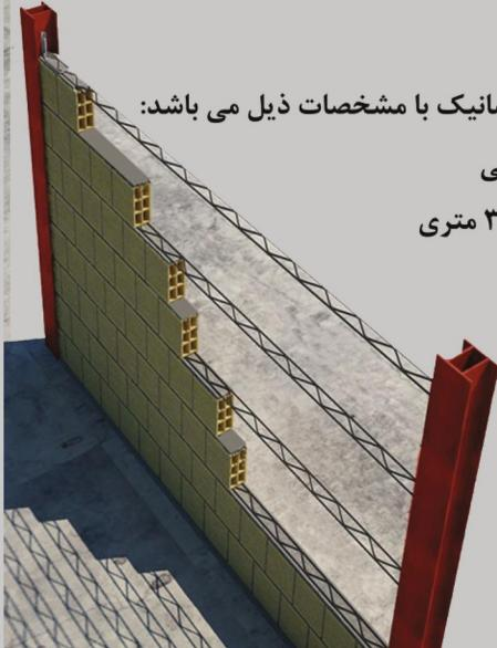
شرکت آهن تولید کننده میلگرد بستر با ماشین آلات تمام اتوماتیک با مشخصات ذیل می باشد:
