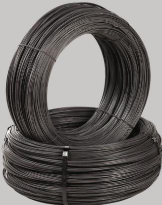
این نوع مفتول از کشش میلگرد کلاف آهن تولید می شود. میلگرد کلاف در دستگاههای کشش مفتول طی چندین مرحله کشیده می شود و طی فرایندهای مکانیکی به سایز دلخواه رسانده می شود. برای کاهش سختی مفتول آهن و افزایش شکل پذیری در عین بالا نگه داشتن مقاومت آن، مفتول ها در کوره های ویژه آنیل تا دمای  $800^{\circ}\text{C}$  و در شرایط خلاء حرارت داده می شود تا کاملاً نرم شده و برای مصارف مختلف آماده گردد.
